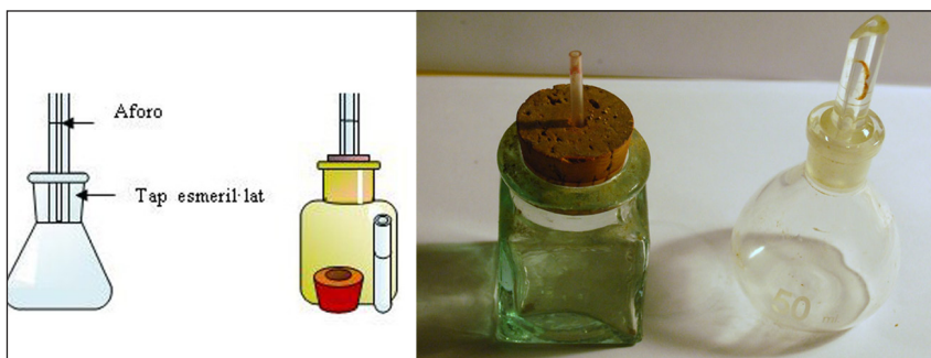
Figura 2. Esquema d'un picnòmetre i imatge d'un picnòmetre estàndard i un altre construït pels alumnes.
